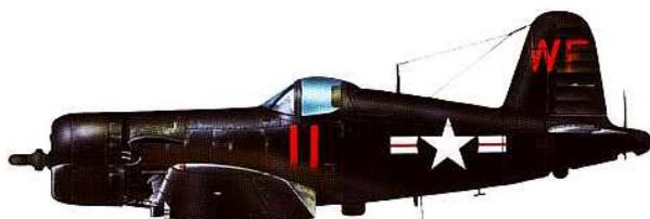
F4U-5NL, VMF(N)-513, Guerra da Coréia. O F4U-5NL tinha bordos reforçados nas asas, na empenagem vertical e nos estabilizadores para suportar o vôo em climas gélidos.
