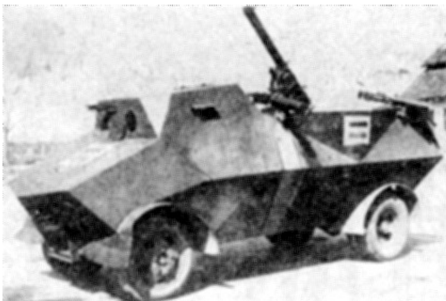
Overvalwagen Braat armado com uma metralhadora AA Colt-Browning M1930 de 12,7 mm, usado para defesa de aeródromos (foto de pós-guerra).
