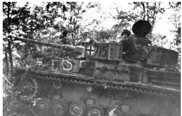
Panzer IVH no front italiano, 1944. Embora o seu projeto já estivesse ultrapassado em 1944, o Panzer IV foi produzido até o fim da guerra, chegando à versão "J", com canhão L/48 de 75 mm.
