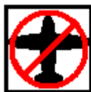
Marcador de Aeródromo Avariado
