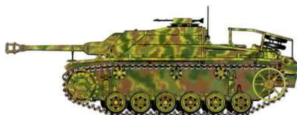
StuG III Ausf. G, Alemanha, primavera de 1945. Este veículo ostenta as últimas modificações feitas no Sturmgeschütz, incluindo a metralhadora operada por controle remoto no teto.
