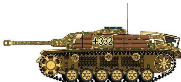
StuG III Ausf. G, unidade ignorada, 1944-45. Este veículo tem troncos de árvores para travessia de terrenos enlameados ou alagados.
