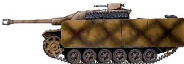
StuG III Ausf. G, unidade ignorada, Prússia Oriental, primavera de 1944. Observe a extensão do Schurtzen à ré. Este veículo apresenta a metralhadora no teto operada por controle remoto.
