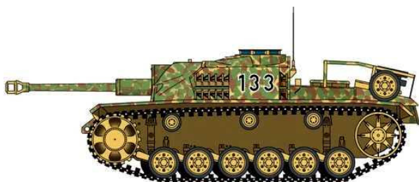
StuG III Ausf. G com blindagem extra de concreto, unidade ignorada, frente oriental, 1944-45.
