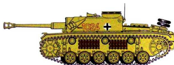
StuG III Ausf. G, 16ª Divisão Panzer, Roma, Itália, novembro de 1943. Este exemplar possui morteiros lançadores de fumaça, os quais eram acionados eletricamente de dentro do veículo. Pedacos de lagarta foram fixados às laterais como um acréscimo à blindagem. Os números são de contornos em vermelho.
