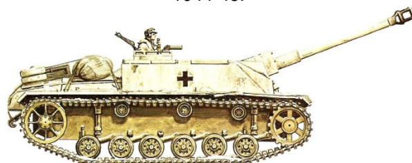
StuG III Ausf. G, unidade ignorada, frente ocidental, inverno de 1944-45. Camuflagem de inverno apenas sobre a superestrutura (a parte de baixo mantém o Dark Yellow). É visível apenas a marcação de nacionalidade.
