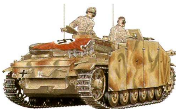
StuG III Ausf. G, 2ª Divisão Panzergrenadier SS "Das Reich", Kursk, Rússia, julho de 1943. A pintura é em Dark Yellow, Red Brown e Dark Green. As duas antenas indicam que se trata de um veículo de comando.
