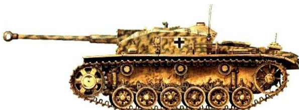
StuG III Ausf. F/8, unidade ignorada, frente russa, 1943. Pintura em Dark Yellow com camuflagem em Dark Green. Este veículo está equipado com um freio de boca tipo "bola", igual ao do Panzer IVF2, o que era muito incomum no StuG.
