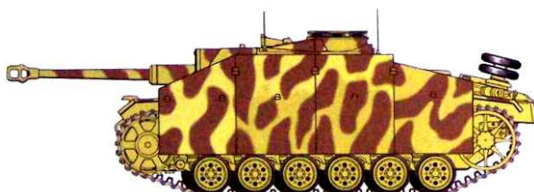
StuG III Ausf. G, Pz.Kp.316 (Fkl 1 ), Alemanha, setembro de 1943. A antena extra instalada na parte da frente à esquerda no teto destina-se ao controle dos veículos de demolição Borgward B IV.
