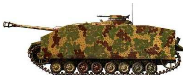
StuG IV, outono de 1944, saindo da linha de montagem da Krupp-Grusonwerk em Magdeburg. A pintura é no esquema "ambush" com a cor básica de Dark Yellow, com Red Brown e Dark Green. Eles recebiam a camada de Zimmerit já na fábrica, mas essa prática foi descontinuada em setembro de 1944.
