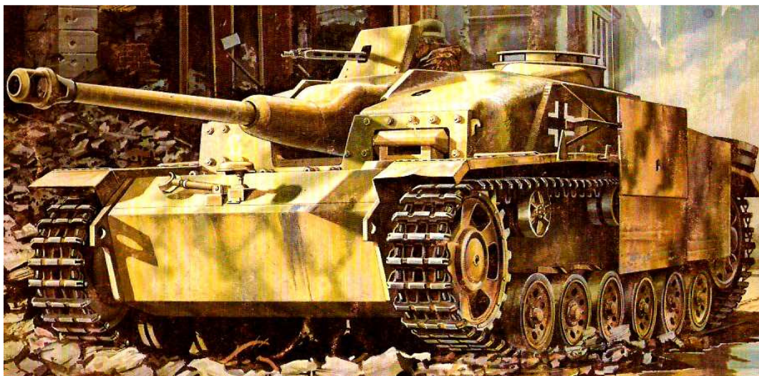
StuG III Ausf.G da Divisão Panzer Lehr, Alemanha, 1945. Este veículo possui blindagem extra de concreto, mantelete “Saukopf” e roletes de retorno da lagarta de aço (sem borracha). Sua camuflagem é a típica de Dark Yellow com faixas de Dark Green.
