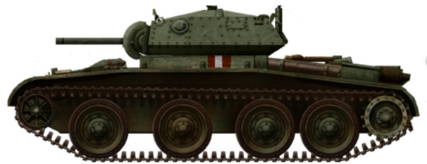
Covenanter Mk.I CS (Close Support). O obuseiro instalado nele era de 76 mm.
