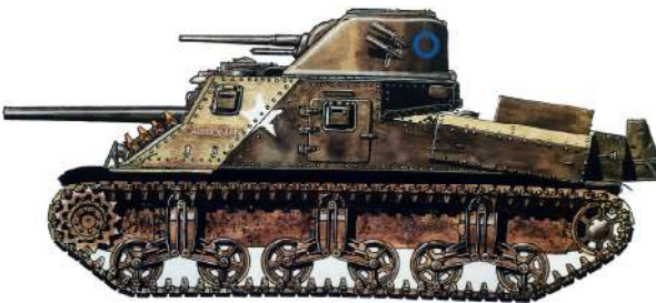
Lee I "Caledonian", Esquadrão "Z", 150º RAC, 254ª Brigada, Birmânia, 1945. Este exemplar emprega o canhão longo de 75 mm.
