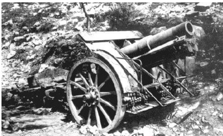
M.14/16 de 15 cm. As estruturas na frente da peça são assentos para o transporte de dois membros da sua guarnição.
