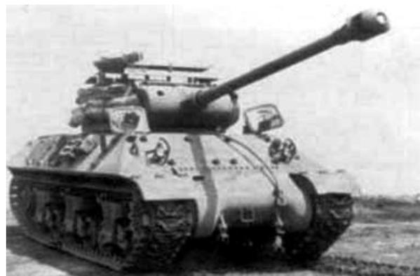
M36B2, baseado no chassi do M10 com motor a Diesel, podia ser equipado com um freio de boca para o canhão.
