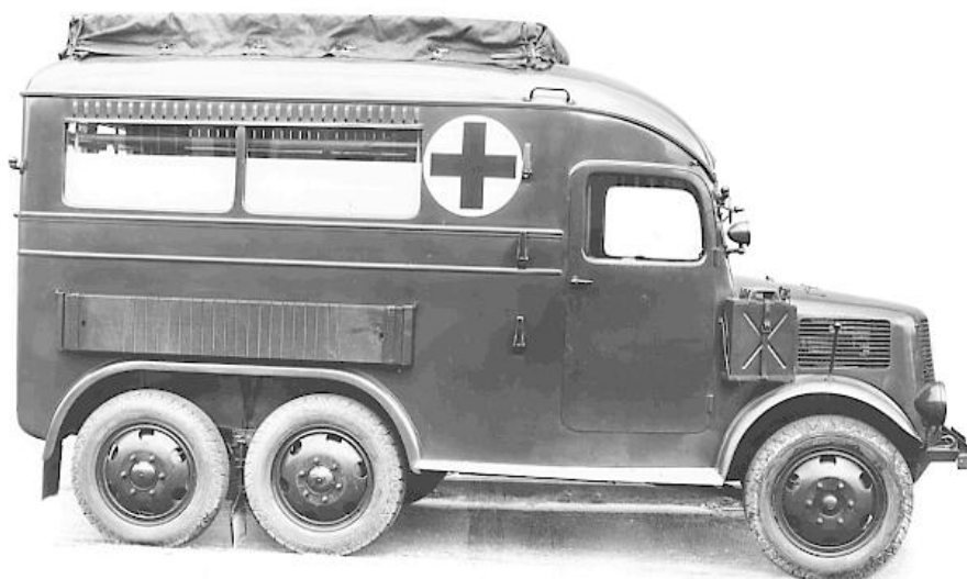
Tatra 92, versão de ambulância. Pode-se distinguir o T 92 do T 93 pelo cubo das rodas dianteiras, que são diferentes.
