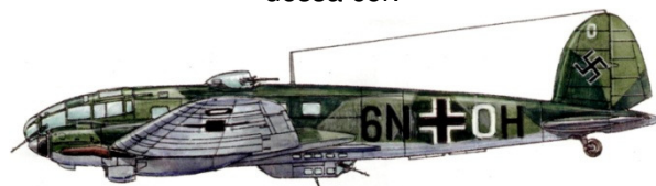
He 111H-3, 1/KGr 100, outono de 1940. O KGr 100 era uma unidade especial de precursoras, com aparelhos equipados com o X-Gërat para navegação noturna usando ondas de rádio.
