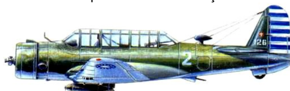
O bombardeiro leve Vultee V-11G 3 (A-19 no US Army) também foi adquirido pela China (30 unidades). Uma versão posterior, o Vultee V-12, teve 60 unidades (das quais, 57 produzidas na China) e equipou o 10º Esquadrão Independente.
