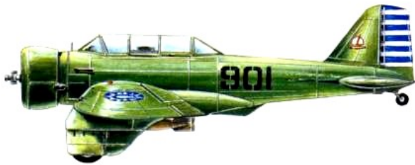
Apesar da China ter encomendado 150 unidades do avião de ataque Northrop 2E Gamma (A-17 no US Army), apenas 49 foram fornecidos, dos quais 25 foram montados na China. Ele equipou o 2º Grupo da Força Aérea chinesa.
