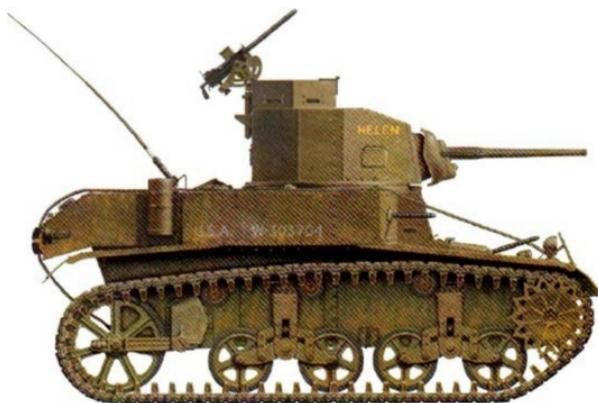
M3, Companhia "B", 192º Batalhão de Tanques, Luzon, Filipinas, dezembro de 1941. Os Stuarts em Luzon eram da versão soldada e com torre octogonal. Os dois batalhões empenhados (192º e 194º) foram perdidos após a queda de Bataã.
