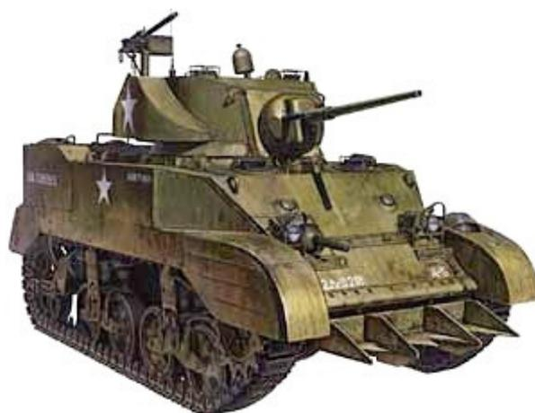
M5A1, Companhia “A”, 92º Esquadrão de Reconhecimento de Cavalaria, 12ª Divisão Blindada, Alemanha, 1945. Observe o “Cullin's Hedgerow Cutter” ou “Cullin's Device”, dispositivo para cortar bocages fixado à frente do veículo.
