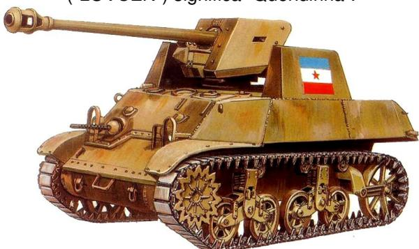
Stuart V armado com um Pak 40, 1ª Brigada de Tanques iugoslava, março de 1945. Esse veículo podia transportar 25 cartuchos de 75 mm. Foram feitas 5 dessas adaptações, 3 das quais ainda eram usadas em 1949.
