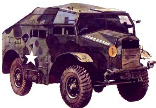
Morris C8 Mk.III "Quad". Observe a marcação de classe de ponte (9/5), indicando a classe do canhão e do veículo, respectivamente.
