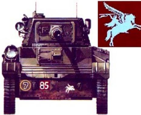
Tetrarch do Esquadrão de QG do 6º Regimento de Reconhecimento, 6ª Divisão Aeroterrestre britânica, lançado na Normandia no “Dia-D”. No detalhe, o símbolo da 6ª Divisão Aeroterrestre britânica<sup>9</sup>. Observe o quadro de arma (85) e a classe de ponte (7).
