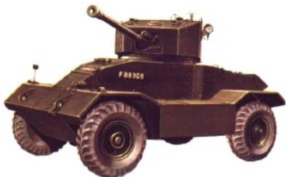
Carro Blindado AEC Mk.III, armado com canhão de 75 mm.
