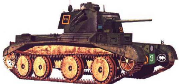
A13 como utilizado pelo 3º RTR, 1ª Divisão Blindada, na campanha da França, em 1940. Embora a camuflagem seja completamente diferente da usada na África do Norte, as outras marcações são idênticas, com exceção da sinalização para pontes (o círculo amarelo com o número "14", na frente do tanque), indicando a classe de pontes que este veículo pode atravessar em função do seu peso (14 toneladas). Obviamente, essa marcação tinha pouca utilidade no deserto.
