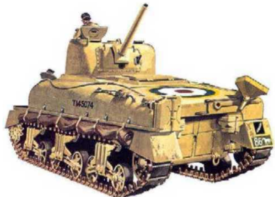
Sherman II, Esquadrão "B", Regimento Royal Wiltshire Yeomanry, 9ª Brigada Blindada. Observe o círculo da RAF pintado sobre o compartimento do motor como forma de identificação aérea.
