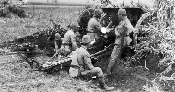
Canhão Tipo 38 de 75 mm, a principal peça de artilharia de campanha japonesa durante a conquista das Filipinas. Embora não fosse projetado para essa função, ele podia ser usado como anti-tanque, usando um projétil perfurante.
