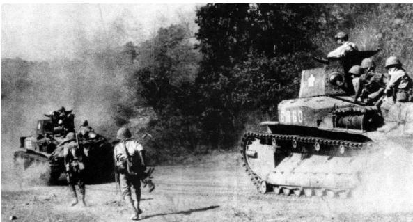
O 7º Regimento de Tanques japonês na Rota 5. Estes são tanques médios Tipo 89 Yi-Go. O 7º Regimento iniciou a campanha equipado com 34 Tipo 89, 14 Tipo 95 e apenas 2 Tipo 97.
